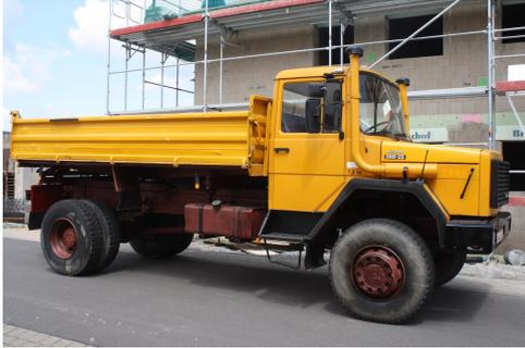
Magirus Allrad Baubulle aus 1. Hand. Der luftgekühlte V8 Motor mit 12675 ccm Hubraum ist bärenstark und der Hauber mit Meiller 3-Seitenkipper geht wie ein Tier. Bereifung 13 R22.5 rundum mit 85 % Profiltiefe. Prüfbuch vorhanden, um die Laufleistung zu dokumentieren. Auch sind alle Bedienungsanleitungen und weitere Literatur im Original dabei. Der Magirus ist nie im Winterdienst gelaufen, sondern wurde jeden Winter abgemeldet.
