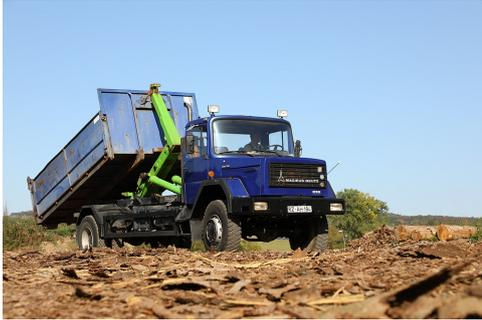
Bereits verkauft: Top gepflegter Magirus M232D16 AK. Allrad mit Meiller Hakenlift. Bereifung 13R22.5. V8 Sauger Deutz luftgekühlt mit 12 Liter Hubraum. Baujahr 1979. 99.900 Kilometer original. Als besonderes Extra ist ein Synchrongetriebe verbaut. Fahrzeug war bereits auf H-Kennzeichen zugelassen. Sofort einsatzbereit. TÜV bis Juli 2021.
