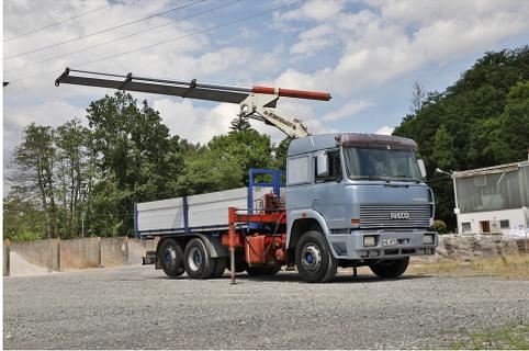
Bereits verkauft: Iveco Turbostar 190-42 Pritsche mit Ladekran, Baujahr 1988, Motor V8Turbo, Leistung 420 PS mit 17,2 l Hubraum, mit Fuller-Getriebe 6x2, Bereifung 315/80 R 22.5, Liftachse, mit bärenstarkem Ing.-Bonovoglio-Kran ausgestattet.
