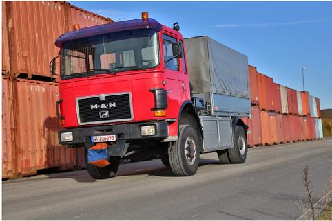
MAN 19.321 FAK, 320 PS Turbo mit Intercooler, Bj. 1984, über 100 km/h schnell, mit umfangreicher Ausstattung wie z.B. AP-Achse vorne und hinten, Längssperre vorne und hinten,
