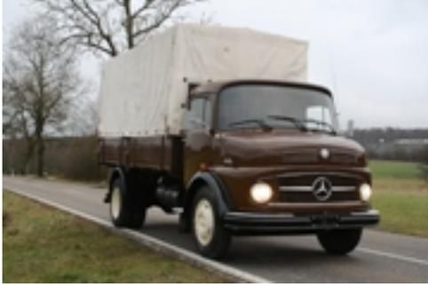
Mercedes L1113 Pritschenwagen, Baujahr 1966, aus zweiter Hand. Der vollkommen originale 1113 zeichnet sich in besonderer Weise durch sein Synchrongetriebe sowie auch die seinerzeit optional zu bestellende Hydrauliklenkung aus.
