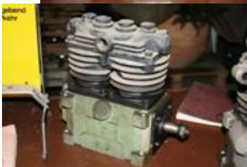
Kompressor Westinghouse passend zu Krupp Typ 459
