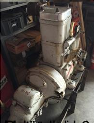
Mercedes-Benz OM591040 Diesel mit ZF-Getriebe
