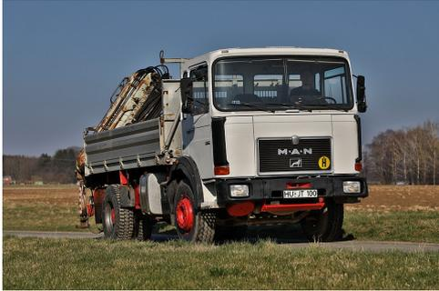
MAN 19.291 3 Seiten Kipper mit abnehmbarem Atlas Kran. Fuller Getriebe. 290 PS aus 12 Litern Hubraum. Baujahr 1986.
