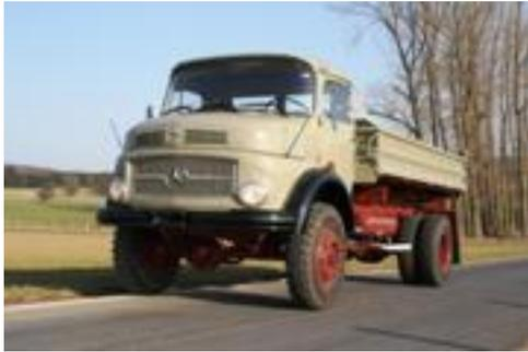
Zur IAA 1969 werden unter der Bezeichnung L 1513 neue Kurzhauber vorgestellt. Diese sind für ein Gesamtgewicht von 14,8 to ausgelegt. Der LAK 1513 ist besonders für die Bauwirtschaft entwickelt worden. Er zeichnet sich durch ein sehr gutes Verhältnis von Eigengewicht zu Nutzlast aus. Bei dem genannten Gesamtgewicht von 14,8 to zeigt er eine Nutzlast von 8.100 kg auf, obwohl es sich um einen Allradwagen handelt.
