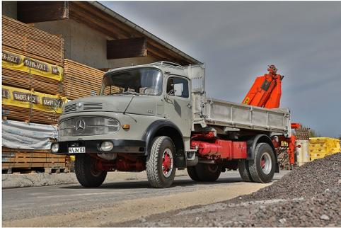
Wir freuen uns, Ihnen diesen 1966 produzierten LAK 1920 anzubieten. Der Wagen wurde an einen Energieversorger ausgeliefert und dort 1976 mit einem absattelbaren Palfinger-Heckkran (Typ PK 11000) ausgestattet. Der weiterhin als Dreiseitenkipper einzusetzende LKW weist ein Getriebe mit Vorschaltgruppe auf (12 Gangstufen). Zudem besitzt er eine Allraduntersetzung. Das Fahrzeug befindet sich in einem absoluten Topzustand und war bereits in der Schweiz als Veteranenfahrzeug zugelassen.
